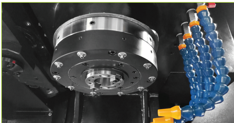
Spindel mit hoher Steifigkeit
