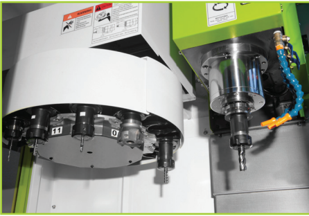
12-fach Werkzeugwechsler mit Schirm
