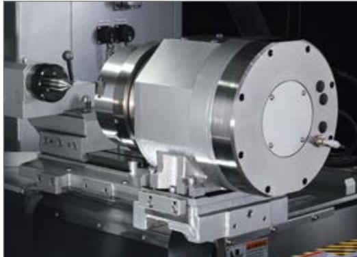
Broche cylindrique avec un dispositif de positionnement des pièces à rectifier
