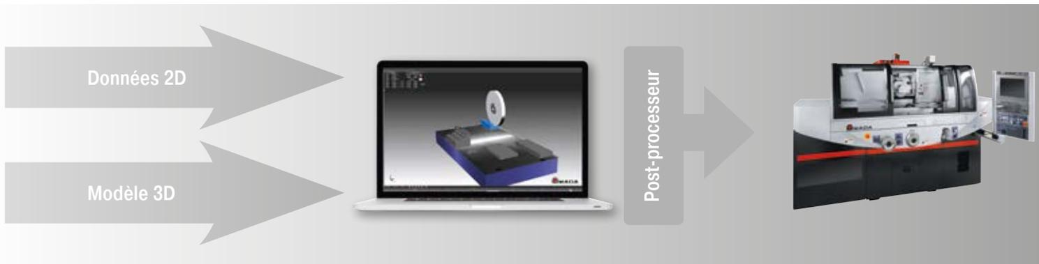
CGS – Complete Grinding Solution, en français la solution de rectification complète, permet une programmation externe globale, y compris de la programmation de contour WinWOP. En commençant par le traitement de données 3D, en passant par les programmes de dressage pour atteindre les technologies complexes pour la commande de la machine, ce concept offre la possibilité de réduire les durées de programmation et d'augmenter la durée de fonctionnement automatisé de la machine.
