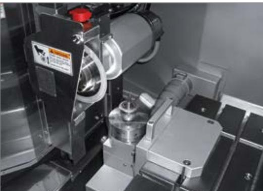
Dispositif de positionnement des pièces à usiner avec 3 positions A-B-C
