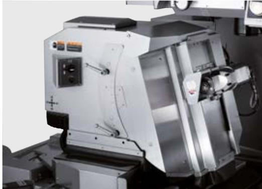
Positionnement automatique des axes (UP)
