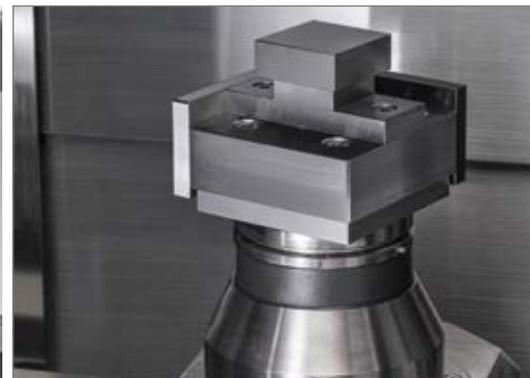
Dispositif de positionnement des pièces à usiner pour un usinage de 5 côtés
