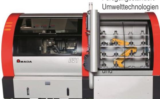
Optische Profilschleifmaschinen mit CCD Kamera
