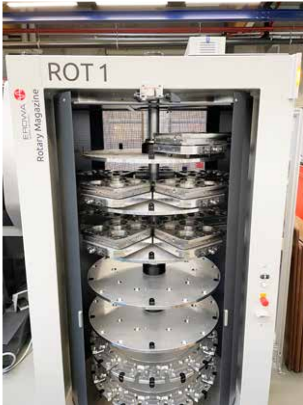
links Der EROWA-Rotary Rundspeicher verfügt über 25 große und 30 kleine Stellplätze.
