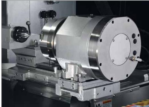
Rundschleifgerät kombiniert mit einem Teilapparat
