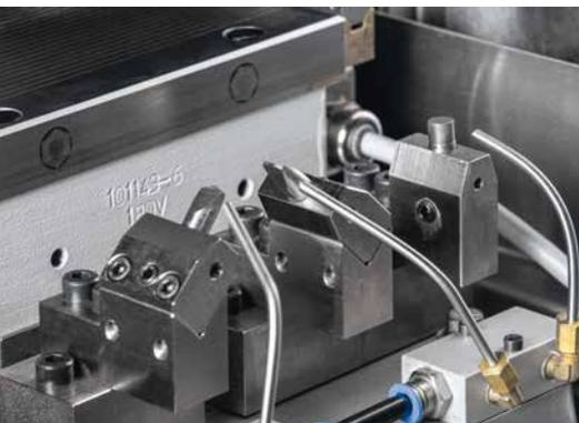
3-Punkt Profilabrichter G3 mit Geradeabrichter
