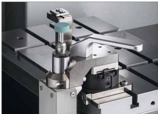
Automatischer Abrichter GLS UP
