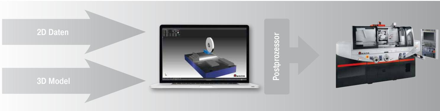
CGS – Complete Grinding Solution, dt. kpl. Schleiflösung, ermöglicht eine gesamtheitliche externe Programmierung, einschließlich der Konturprogrammierung WinWOP. Beginnend mit der Verarbeitung von 3D Daten, über Abrichtprogramme bis zu komplexen Technologien zur Steuerung der Maschine, bietet es die Möglichkeit Programmierzeiten zu verkürzen und die automatisierte Maschinenlaufzeit zu erhöhen.
