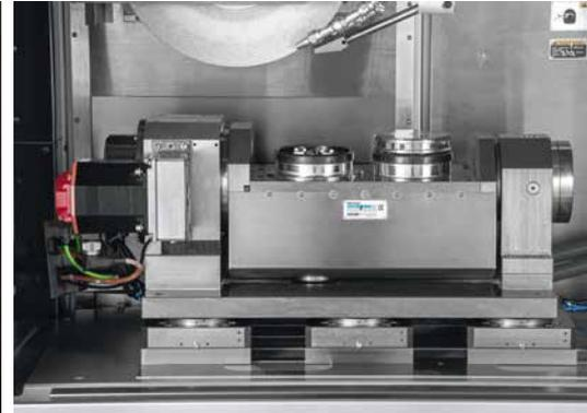
Nullpunkt-Spannsystem mit Teilapparat
