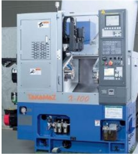
Takamaz X-100 Drehzentrum Takamax X-100 mit CNC Fanuc 0i-TC und automatischem Werkstücklader
