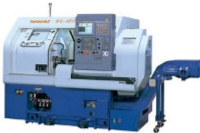
Takamaz XY-120 Drehzentrum Takamax XY-120 mit CNC Fanuc 0i-TC
